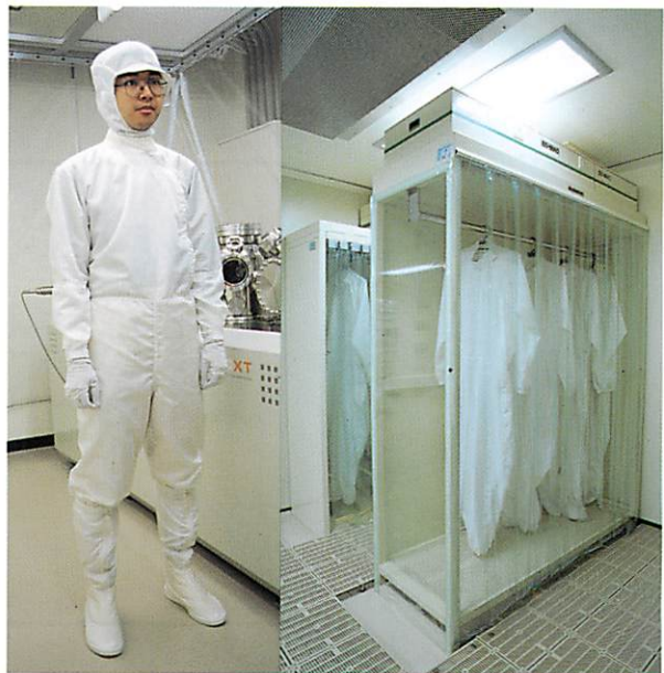
図1.17 防塵衣 ガーメントストッカー
