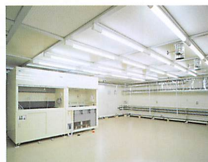
ウェットプロセス室 (Class 1) 大口径シリコンウエハ、全長1mのSR光ミラー等の大面積試料の洗浄が可能な、少排気量型クリーンドラフトチャンバーを設置しています。
