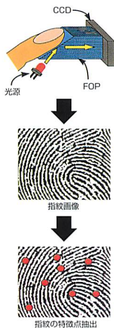
図5.5 ファイバーオプティックプレート (FOP: Fiber Optic Plate) センサーによる指紋照合 2)
